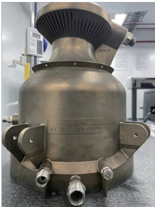
<그림 9> 3D 프린터를 이용해 단품으로 제작한 아그니쿨의 로켓 엔진. (아그니쿨 제공) [10]
