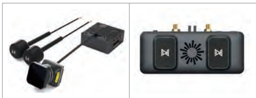
〈그림 8〉드론용 고화질 송신기와 카메라, 수신기(Caddx)
