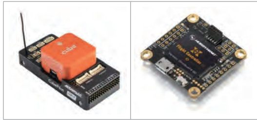
〈그림 2〉 센서형 드론 FC(Pixhawk)와 FPV드론 FC(Hobbywing)
