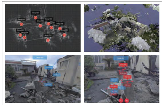
〈그림 7〉 제주 창고 화재 순직사고 현장 3D 스캐닝 측정
