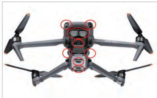
〈그림 3〉 센서형 드론(DJI) 기체에 장착된 각종 센서(적색원)
