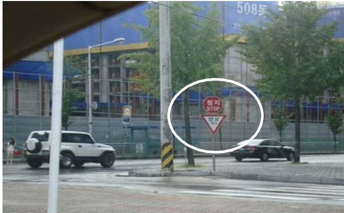
<그림 3-13> 일시정지와 양보 안전표지 혼재 설치 사례 5
