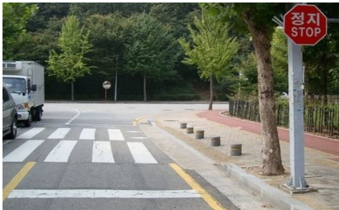
<그림 3-3> 기능을 고려하지 않은 일시정지 안전표지 설치 사례
