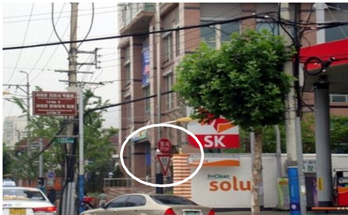
<그림 3-10> 일시정지와 양보 안전표지 혼재 설치 사례 2
