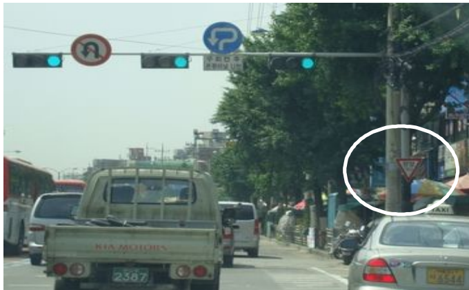
〈그림 3-16〉 교통신호기와 양보 안전표지 혼재 설치 사례 2
