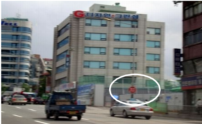
<그림 3-21> 방향이 틀리게 설치된 일시정지 안전표지 설치 사례 2
