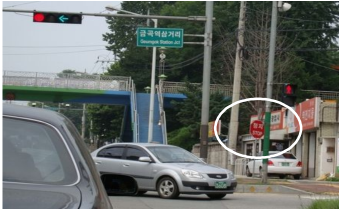
〈그림 3-8〉 교통신호기와 일시정지 안전표지 혼재 설치 사례 5
