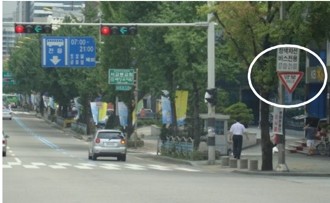
〈그림 3-15〉 교통신호기와 양보 안전표지 혼재 설치 사례 1
