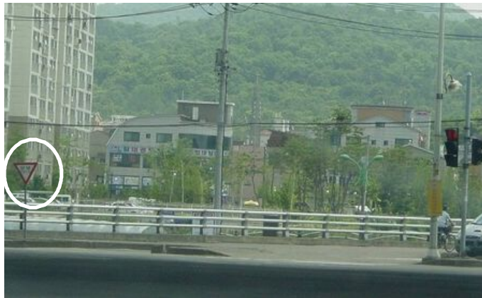
〈그림 3-19〉 방향이 틀리게 설치된 양보 안전표지 설치 사례 3
