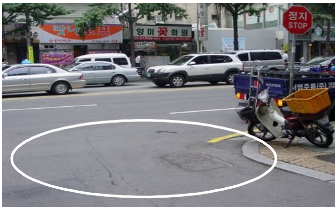
〈그림 3-2〉 정지선과 함께 설치되지 않은 일시정지 안전표지 설치 사례
